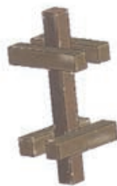
Support d'ancrage. Montage en bois excluant tout béton.
